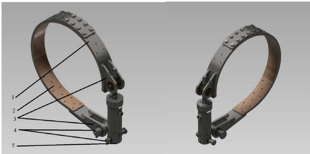
Слика 5.7 Појасна кочница: 1 – кочиона трака; 2 – ферода; 3- ушке; 4 – осовинице и 5 – хидраулучни цилиндар
