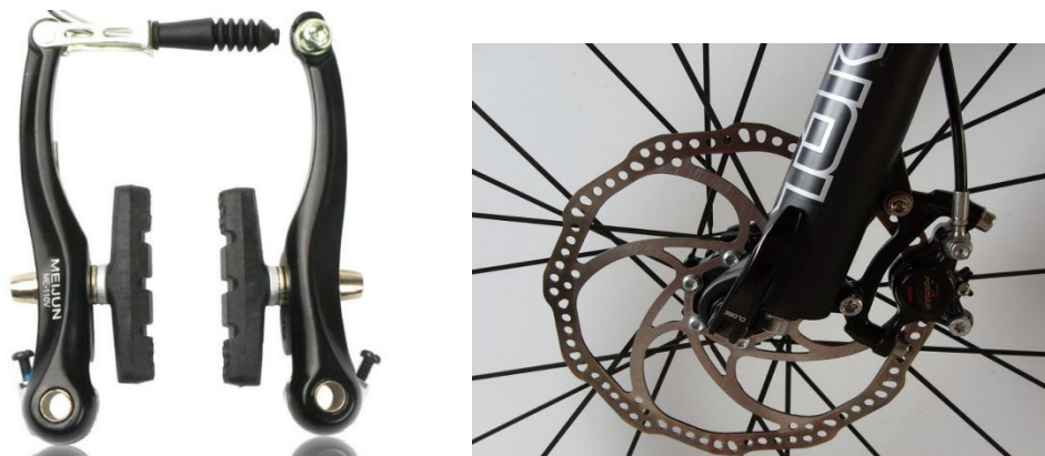
Слика 16. „Бандаш” кочница (лево) и хидраулична-диск кочница (десно), [11]
