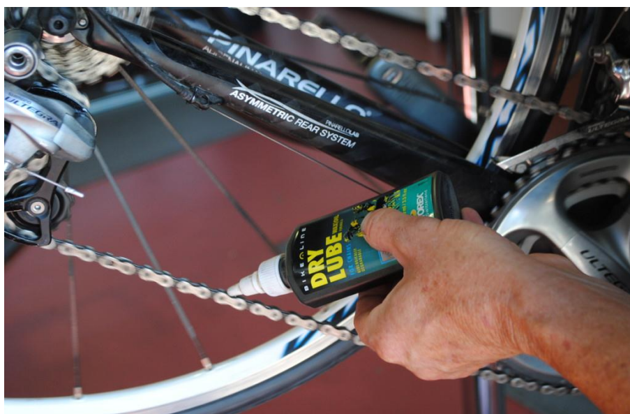
Слика 21. Подмазивање ланца, [12]
