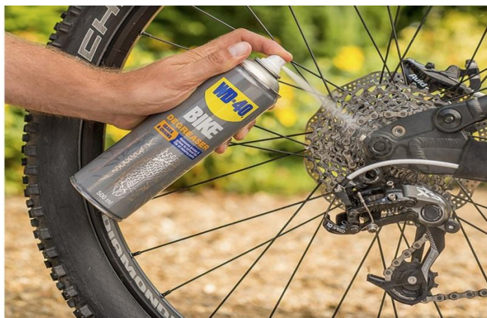
Слика 20. Чишћење ланца помоћу WD-40, [13]
