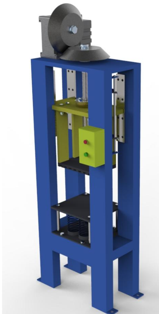
Слика 7.1. Приказ 3д модела фрикционе пресе
