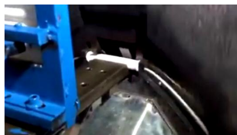
Слика 4.1.8.4. Преса у тренутку савијања поцинковане жице
