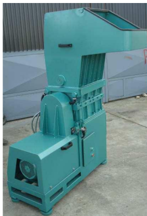
Слика 4.1.7.3. Млин за млевење отпадне пластике марке ELDON
