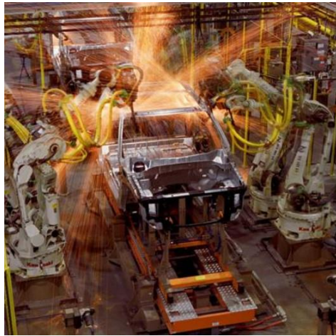
Слика 5а: Роботи за заваривање [8]
