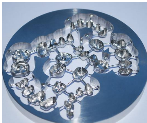
Слика 5.3 Co-Cr ортодонтски мост коришћен у протетичарске сврхе
