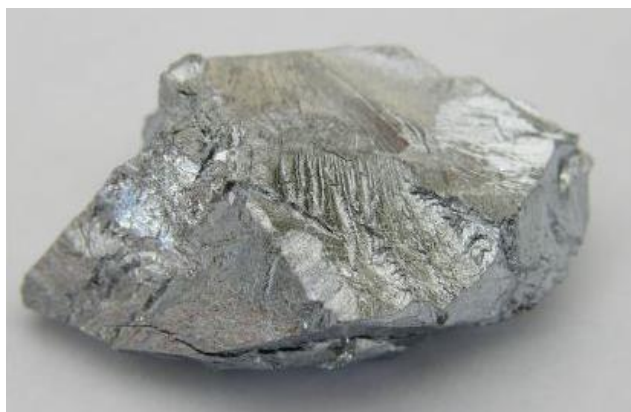
Слика 4.2 Чист комад хрома, добијен алуминотермијском редукцијом
