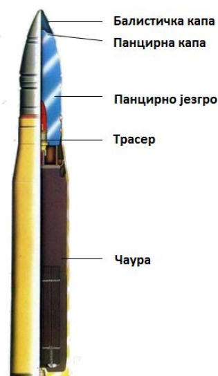
Слика 2.3. Панцирни пројектил – калибарни [9]
