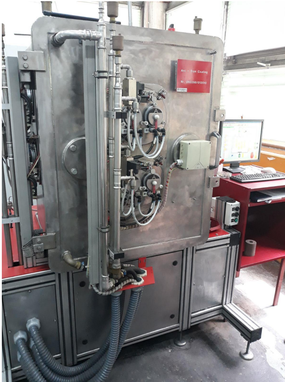
Слика 43. Комора за наношење превлака
