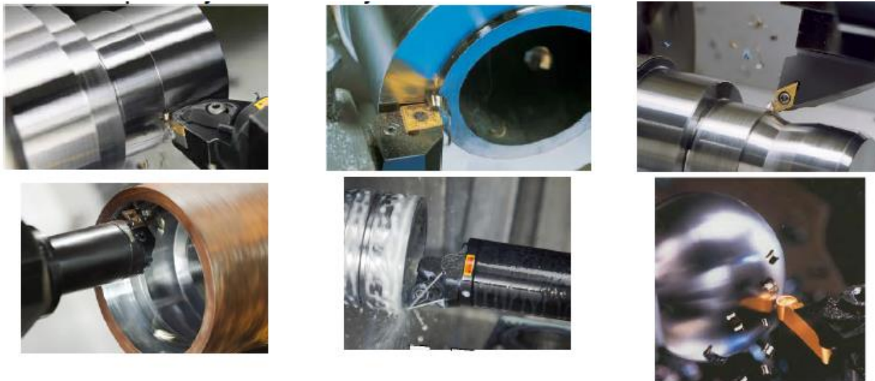
Слика 30. Основне операције у обради стругањем [4]
