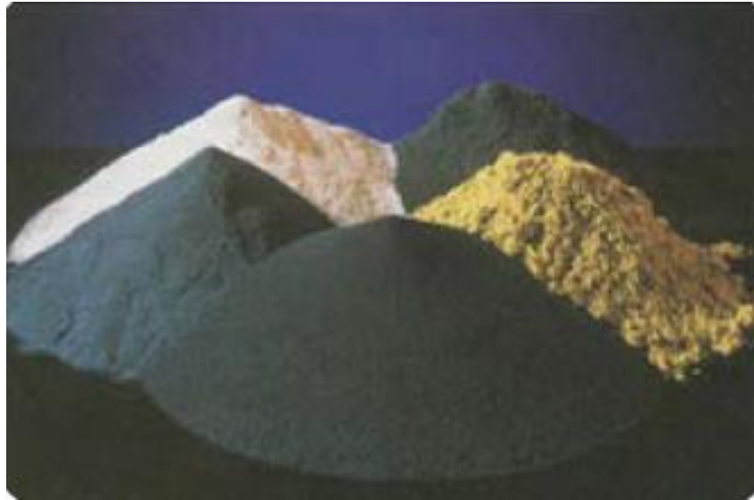
Слика 4. Цементирани карбид се добија мешањем, подмазивањем, консолидацијом и синтеровањем из праха, формирајући компактан синтеровани цементирани карбид [1]
