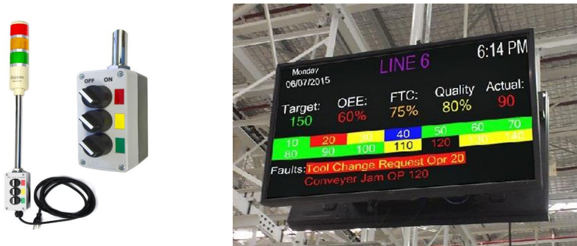
Слика 4. Класичнији пример andon семафора са ручним прекидачима (лево) и пример andon екрана, повезаног са машинама, на коме се читавају разне информације (десно)
