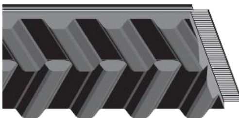
Слика 13. Стреласти профил каиша
