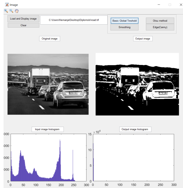
Слика 34. Слика без замућења, примена методе са средњом вредношћу за праг
