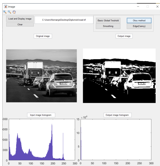
Слика 36. Слика без замућења, примена Otsu методе
