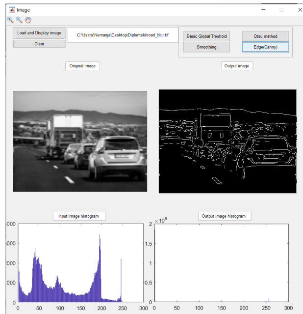
Слика 39. Слика са замућењем, примена Сеппу методе
