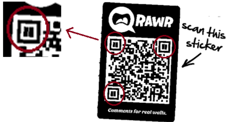
Слика 24 – Слика QR кода са означеним кандидатима за позиционе обрасце након хоризонталне претраге
