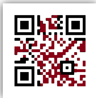
Слика 8 – Подаци и модули за исправљање грешака
