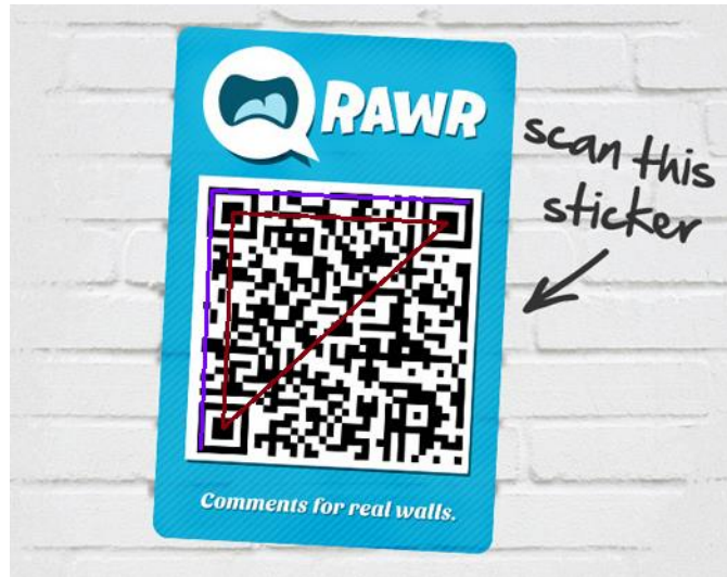
Слика 28 – Слика QR кода са означеним проширеном троуглом (љубичастом бојом)
