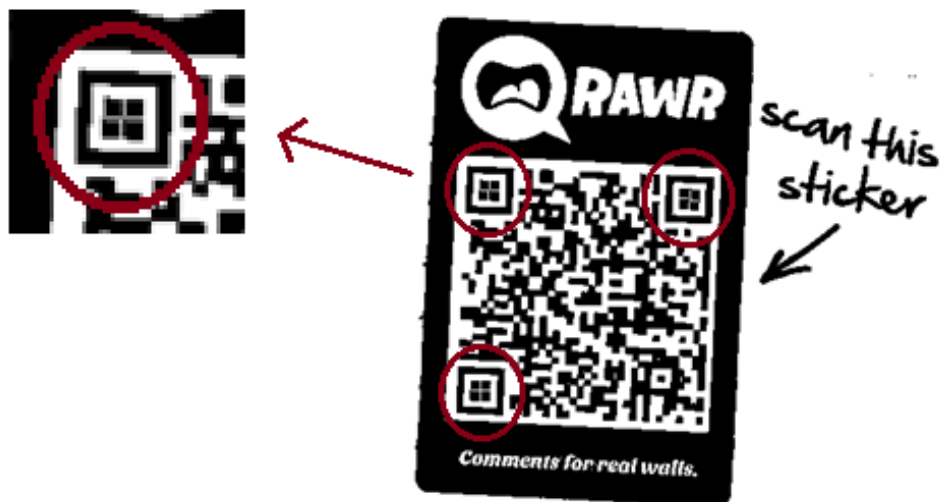
Слика 25 – Слика QR кода са означеним кандидатима за позиционе обрасце након хоризонталне и вертикалне претраге
