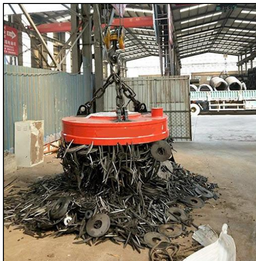
Слика 11 : Приказ електромагнета у току рада[10]
