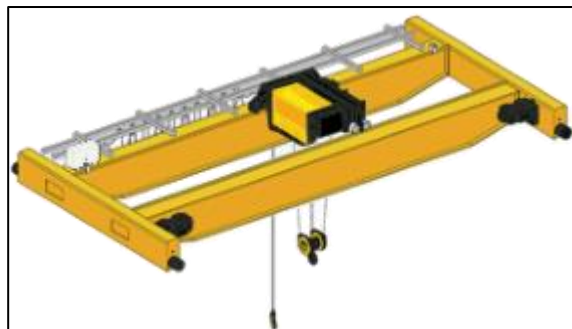
Слика 7: Двогредна мосна дизалица [6]
