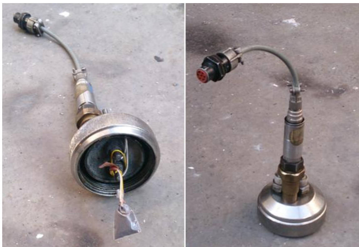
Слика 36. Данце манометарске бомбе са кесицом и давачем притиска
