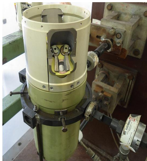
Слика 11. Механичке препреке за скретање млаза продуката сагоревања ракетног мотора
