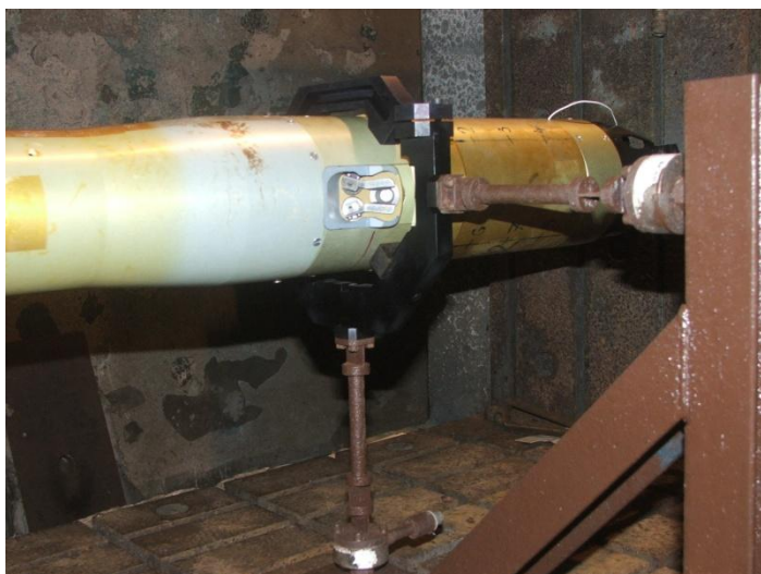
Слика 11. Механичке препреке за скретање млаза продуката сагоревања ракетног мотора
