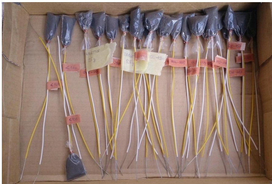
Слика 32. Кесице са смешом и електроично-запаљивом главицом за активирање смеше
