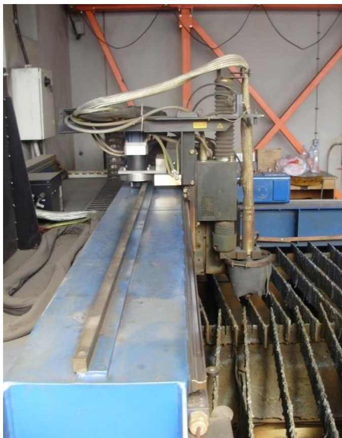
Слика 3.4 Попречна шина за кретање по Y осе
