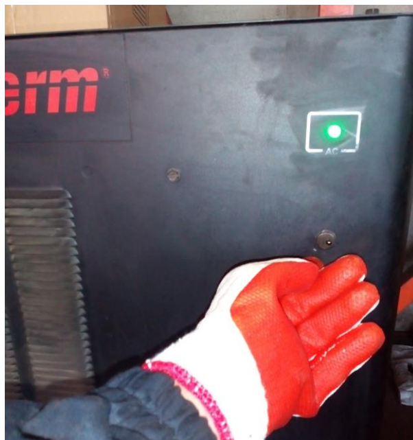
Слика 3.30 Укључивање плазме
