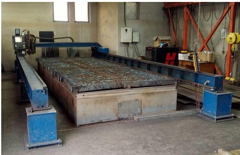
Слика 3.3 Радни сто са двостраним шинама за кретање по Х оси
