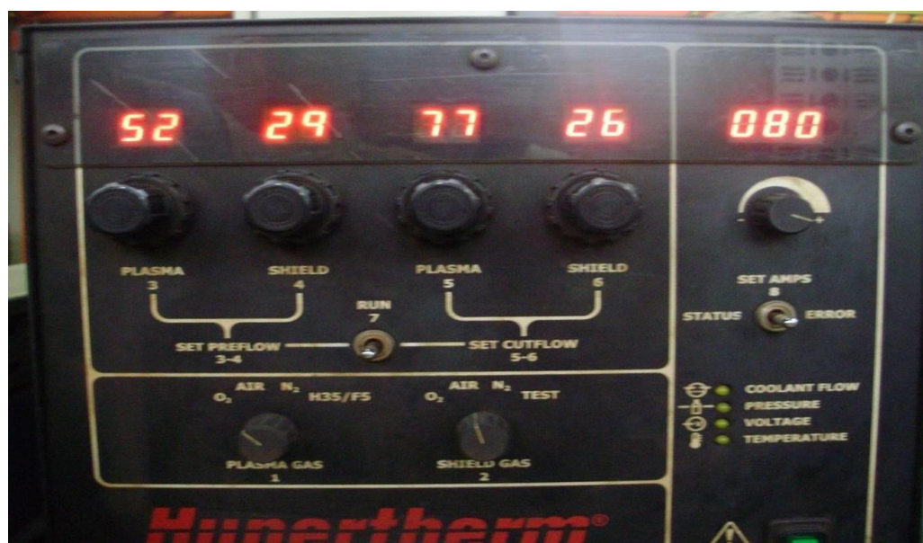
Слика 3.31 Подешавање гасова и јачине струје
