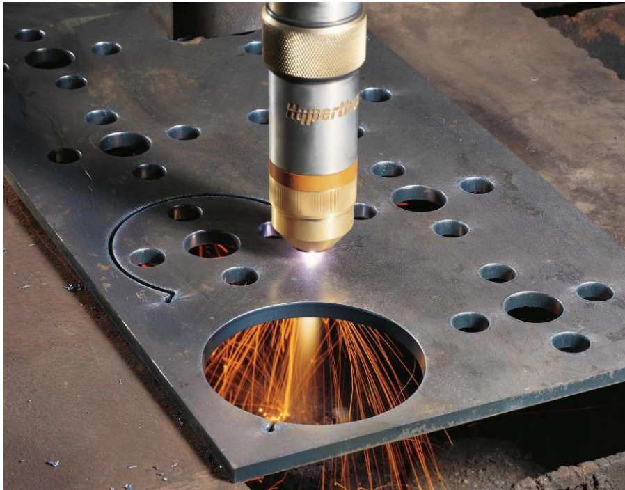
Слика 2.2 Сечење плазмом [4]
