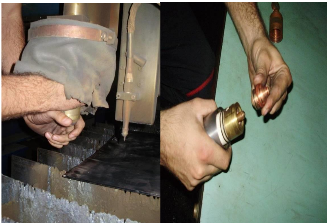
Слика 3.33 Скидање главе и монтирање електроде од 80А
