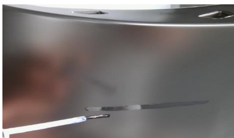
Слика 40. Пример успешног пламеновања
