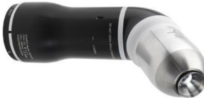
Слика 45. Ротирајући атоизер на врху шесте осе робота
