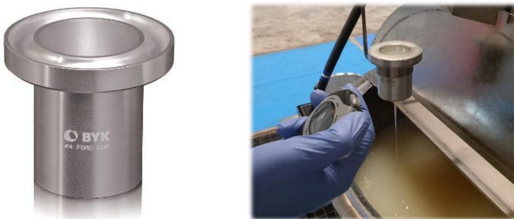
Слика 60. FORD CUP за мерење вискозности боје; приказ поступка мерења
