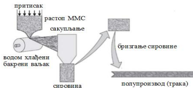
Слика 23. Поступак брзог очвршћивања (RSP) [5]
