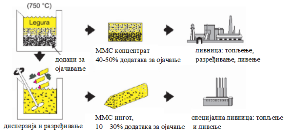
Слика 20. ММС производња инфилтрацијом без притиска [5]
