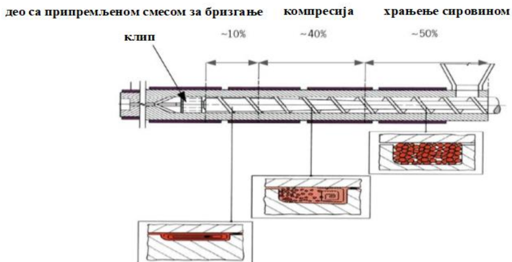
Слика 45. Шематски приказ промене структуре сировине при бризгању [5]
