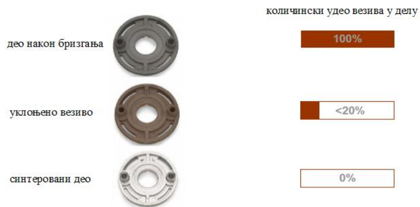
Слика 41. Постепено уклањање везива током MIM процеса [9]
