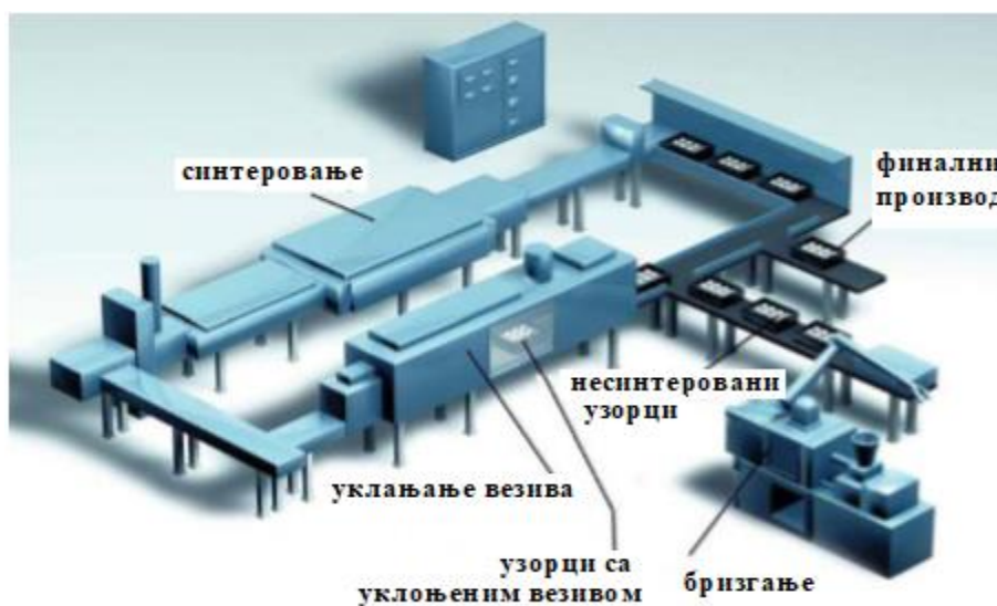
Слика 36. Аутоматизована линија за инјекционо бризгање металних прахова [8]
