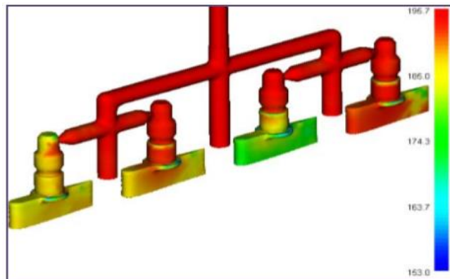
Слика 61. Расподела температуре на крају процеса пуњења калупа ( ^{\circ}\text{C} ) [5]
