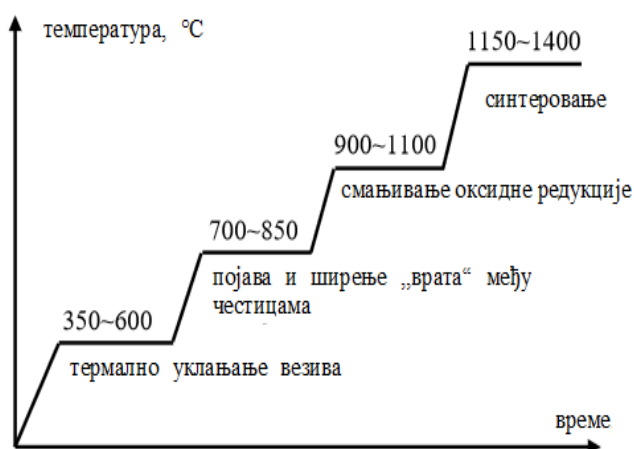
Слика 51. График циклуса током синтеровања и пресинтеровања у четири фазе за нерђајући челик [5]
