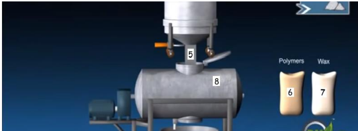
Слика 67. Процес сједињавања масе уз додавање полимера и пуниоца(5-смеша из суда 4; 5-суд са полимером; 6-суд са пуниоцем; 8-суд у коме се врши сједињавање компонената) [11]
