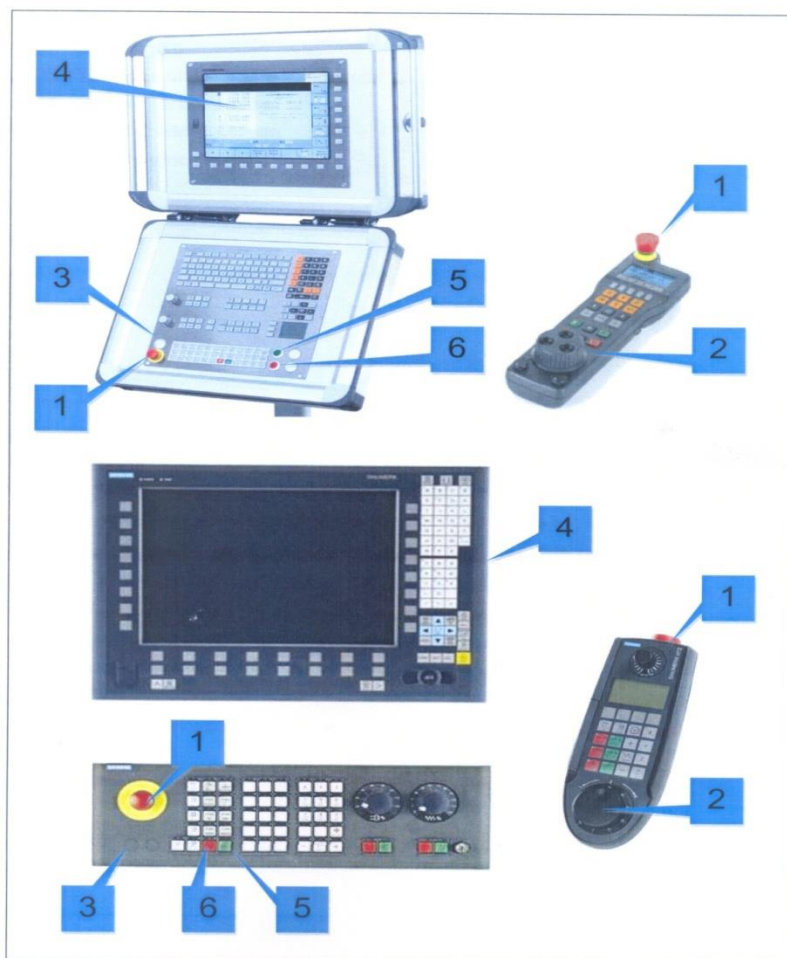
Слика 12 – Управљачки панел (позиције) [4]
