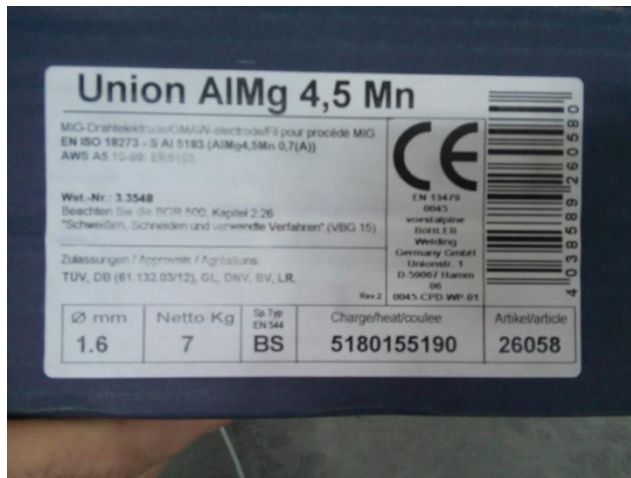
Слика 41 – Глава заваривања (лево) и спецификација жице (десно)
