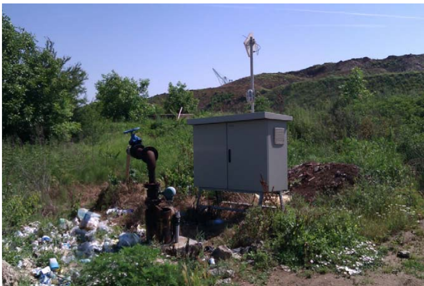
Слика 5.5. Изглед опреме за управљање системом одводњавања на Копу „Дрмно“
