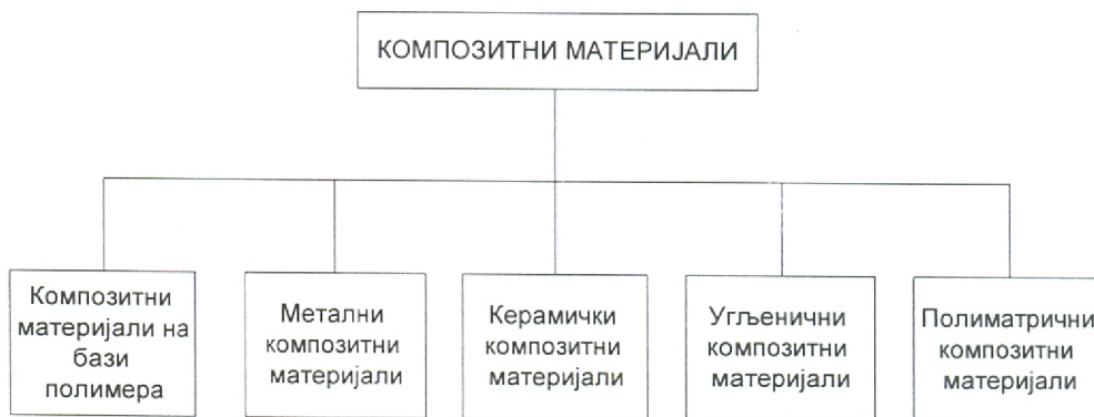
Слика 3.1 Подела композитних материјала у зависности од материјала матрице [2]
