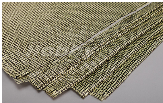
Слика 6.4.2.1.1. Хибридно платно од арамидних и угљеничних влакана, производ фирме Hexcel-Genin. [2]
