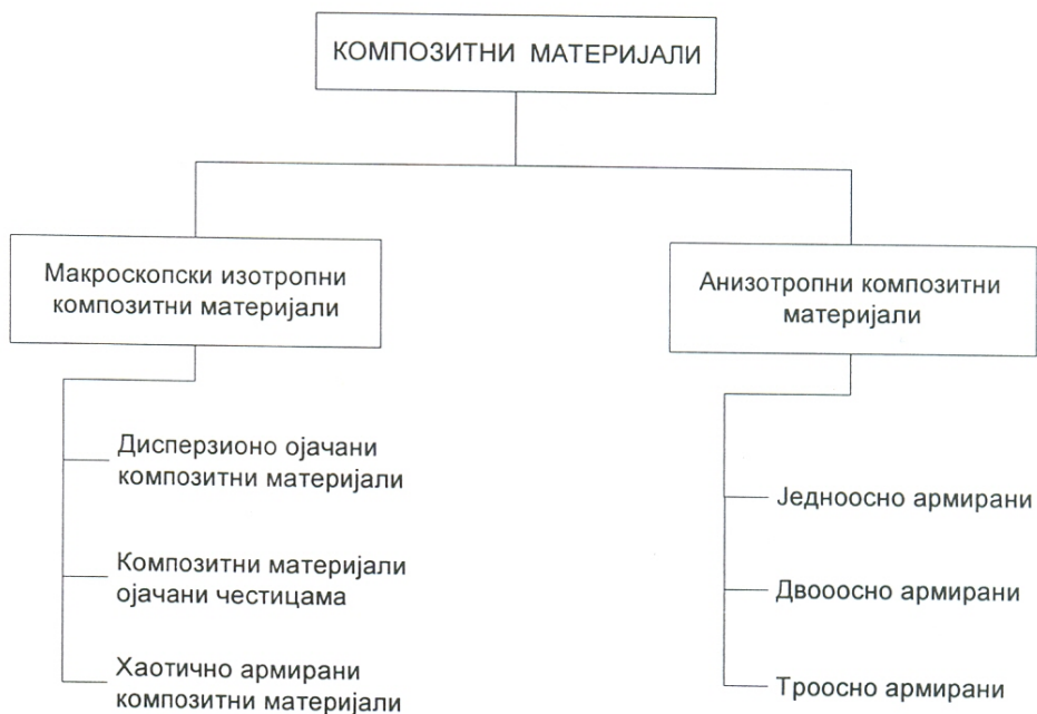
Слика 3.4. Подела композита у зависности од геометрије армирајућих елемената и њиховог међусобног распореда [2]
