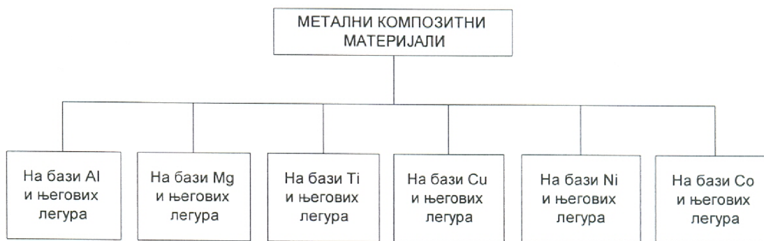
Слика 4.1 Подела металних композитних материјала у зависности од материјала матрице [2]
