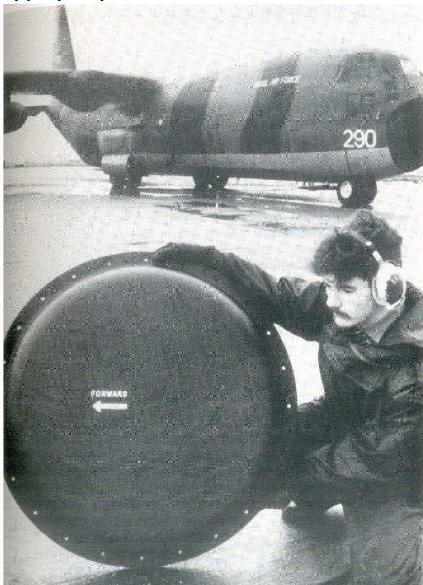
Слика 2.19 Испупчена радарска купола транспортног авиона Херкул, уведена због веће отпорности на ударе камења на писти.[2]
