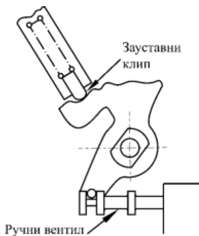
Слика 27. Позиционирање ручног вентила [12]
