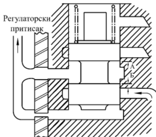
Слика 11. Вентил малог протока за регулацију притиска [9]
