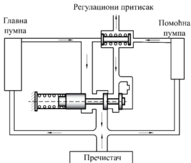
Слика 16. Регулационо хидрауличко коло са две пумпе за уље [12]
