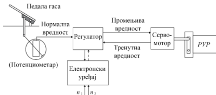
Слика 32. Електронски пренос сигнала о оптерећењу мотора [9]
