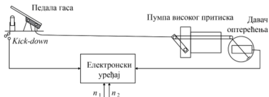
Слика 31. Електромеханички пренос сигнала о оптерећењу мотора [11]
