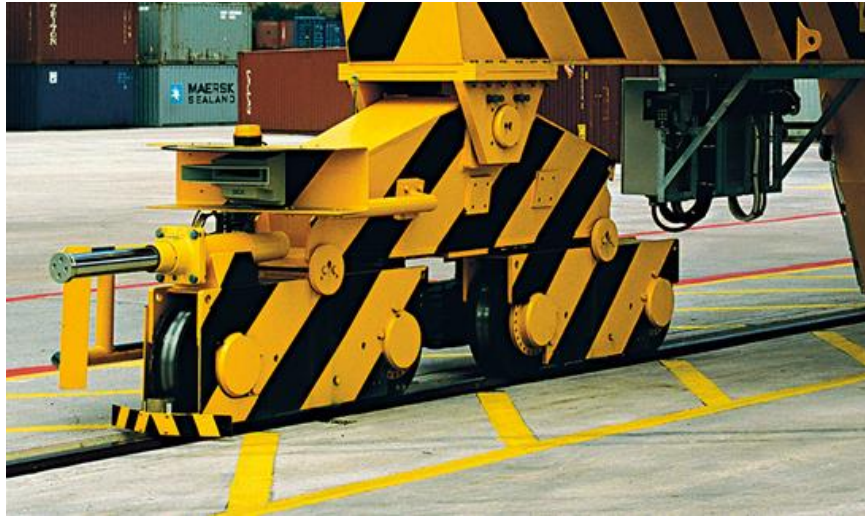
Слика 4.13. Погонски механизам за кретање рамних дизалица [11]
