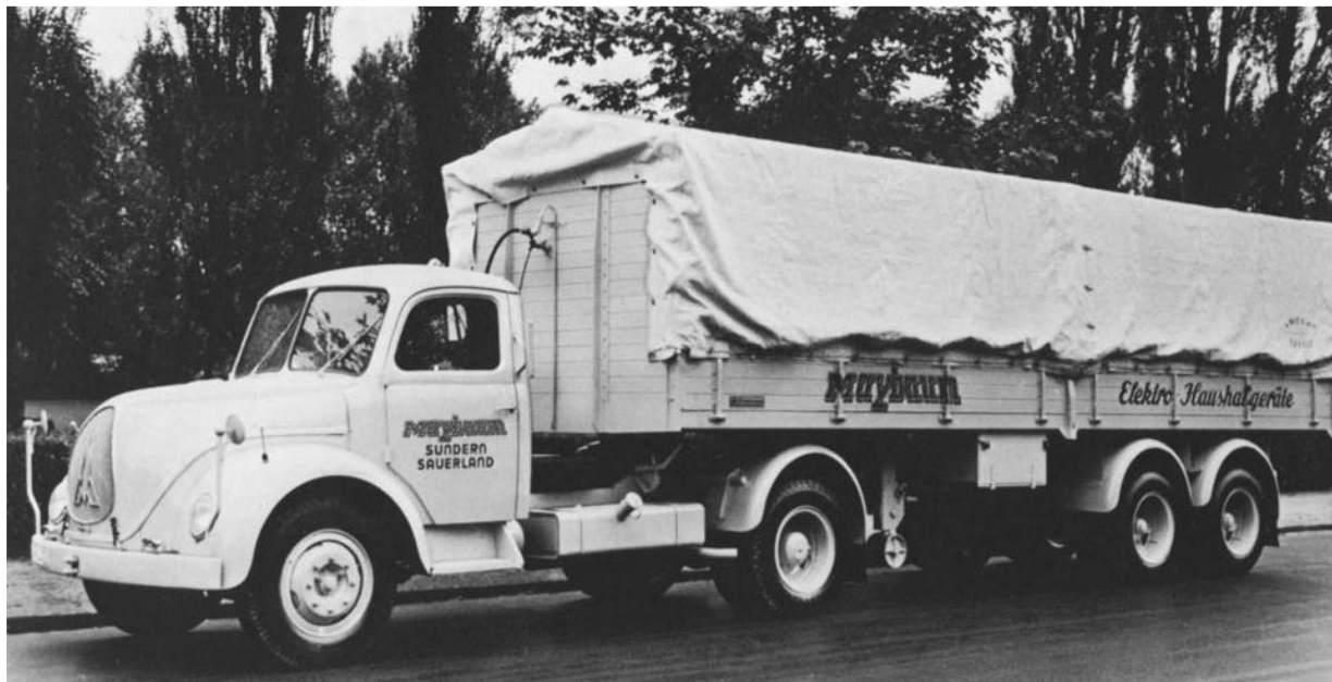
Слика 2. Даимлер-Бенз модел L 223 са дизел мотором и гасним турбопуњачем [3]
