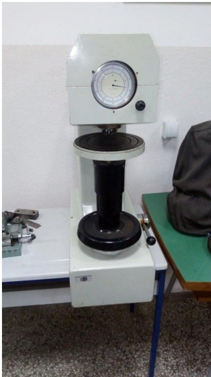
Слика 4.3. Механички уређај за мерење тврдоће по Роквелу
