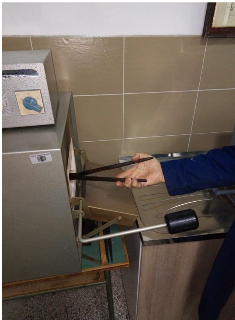
Слика 2.1 Пећ коришћена за загревање до температуре каљења приликом убацивања епрувета
