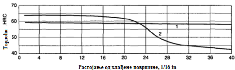
Слика 3.14 Дијаграм прокаљивости алатног челика за топао рад легираног хромом H12 (1) и његове модификације без додатка молибдена (2) [1]
