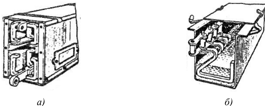
Слика 2.3.2. Попречни пресек транспортера са профилисаним стругачима, а – код вертикално затворених контура, б – код хоризонтално затворене контуре
