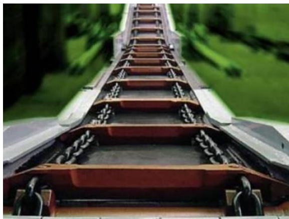
Слика 3.1.5. Транспортер са ниским стругачима облика пуних плоча намењен за транспорт материјала у јамским рудницама
