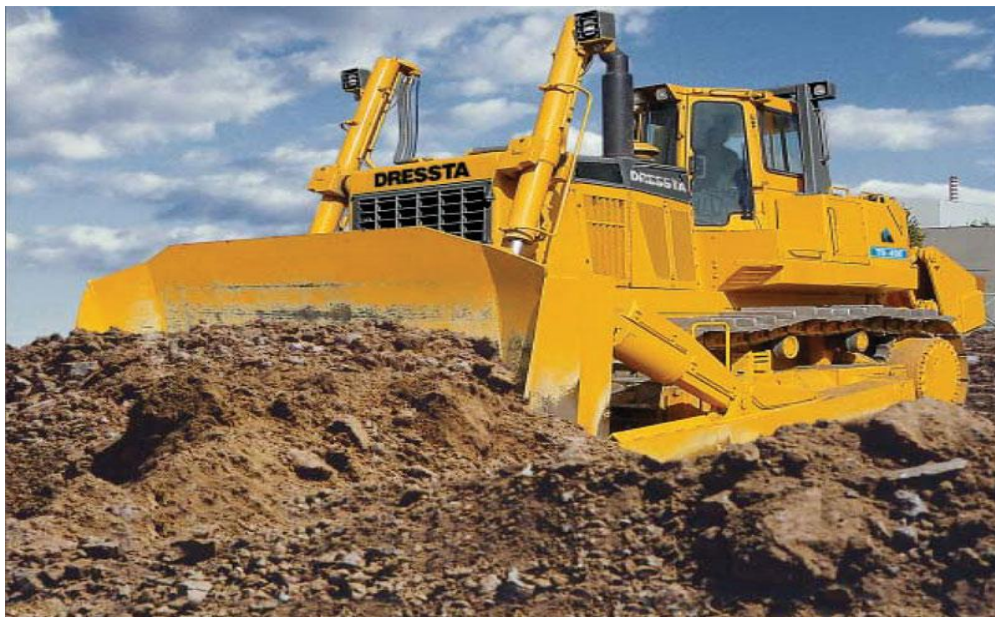
Слика 3. Формирање земљане призме испред ножа булдозера
