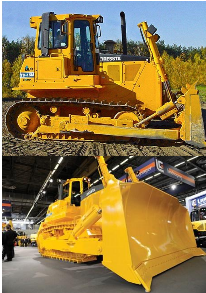
Слика 7. Разлика у габаритима булдозера, горе (мањи), доле (већи)
