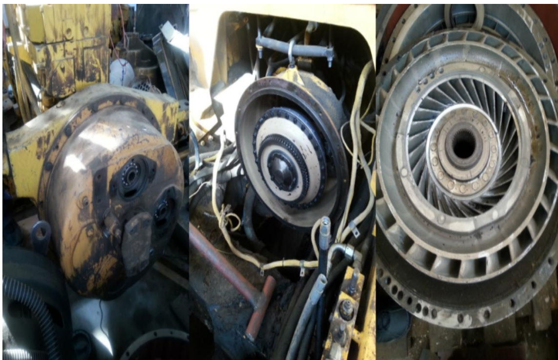
Слика 12. Торк конвертор, на мотору, редуктору и лопатице које се налазе у склопу торк конвертора
