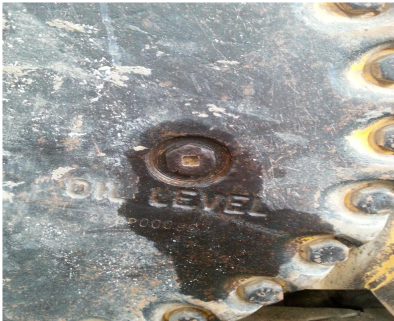
Слика 16. Чеп за читавање нивоа уља у бочном редуктору
