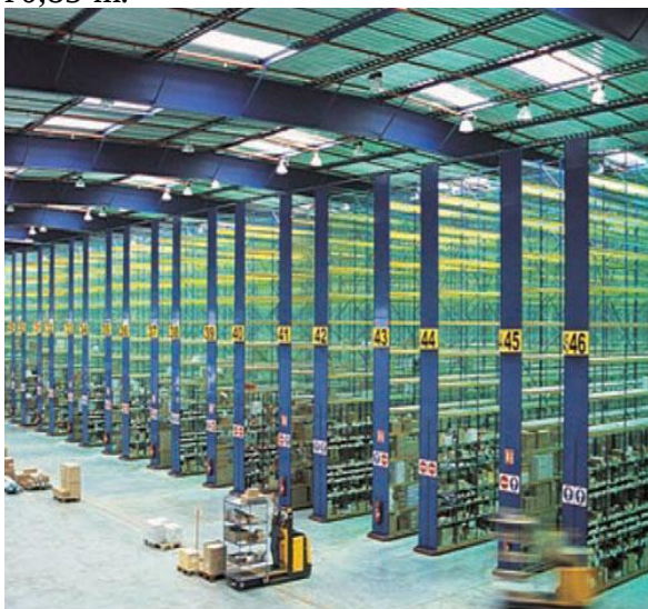
Slika 13. Polični sistem koji obezbeđuje veliki broj poličnih nivoa i veliku nosivost (100-230 kg po polici).
