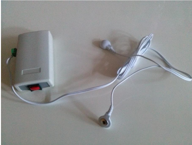
Слика 3.10: ЕДА уређај за који се користи егзосоматична метода са НС.
