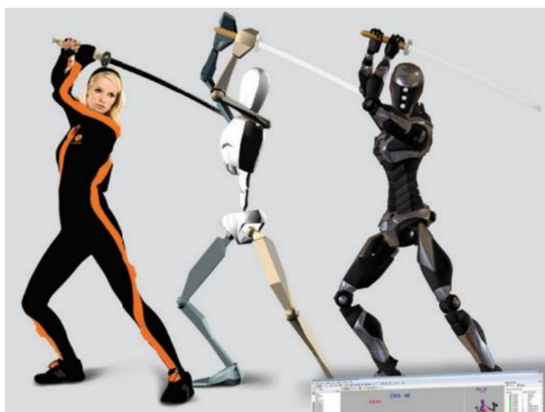
Слика 2.11: На слици је приказан пример Xsens система за снимање покрета без камере, који би могао да се искористи за неку видео игру или анимирани филм [30].
