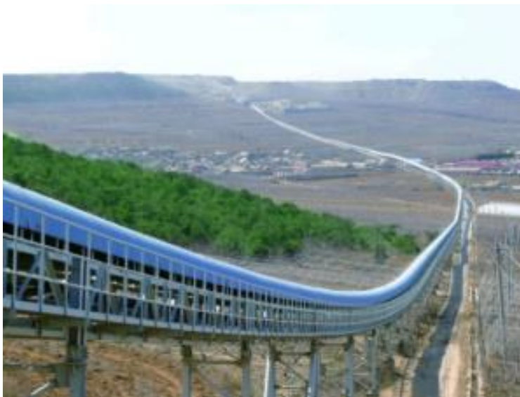
Слика 5.2 Тракасти транспортер са заштитом од спољних утицаја
