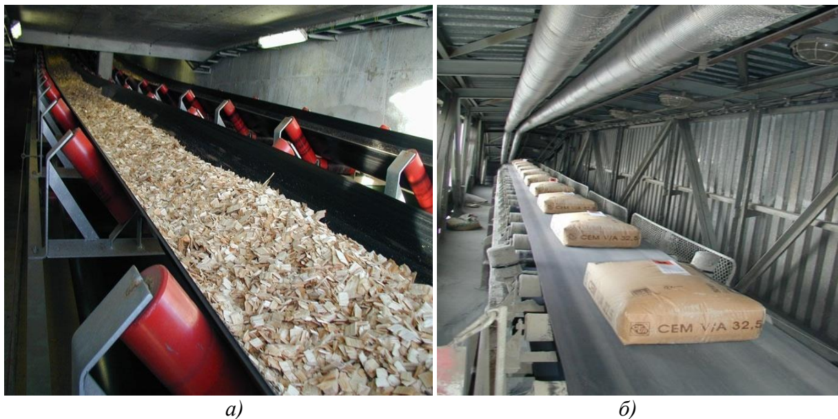
Слика 4.7 Транспорт расипног а) и комадног б) материјала транспортном траком
