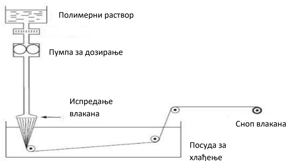
Слика 13. Процес добијања арамидних влакана (кевлар). [14]
