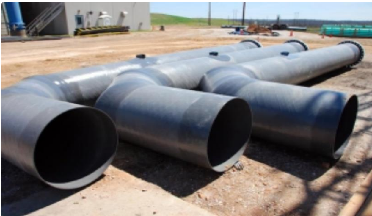
Слика 7. Цеви изграђене да полимерних композитних материјала ојачаних стакленим влакнима. [9]
