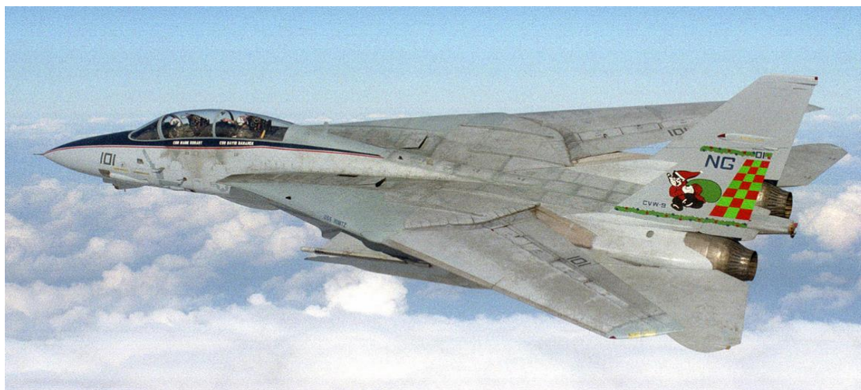
Слика 17. Амерички борбени авион F-14A Томсат, који садржи компоненте ојачане боровим влакнима. [3]
