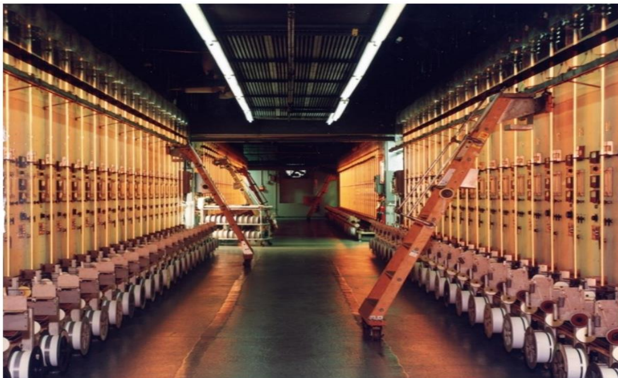
Слика 16. Реактори за добијање борових влакана. [18]
