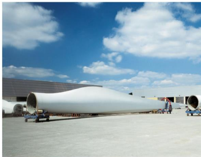
Слика 6. Примена полимерних композитних материјала ојачаних стакленим влакнима у конструкцији ветрењача. [8]
