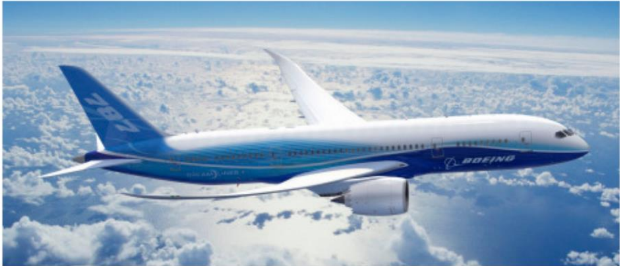
Слика 9. Авион Boeing 787 Dreamliner, где је проценат композита у конструкцији 80%. [11]
