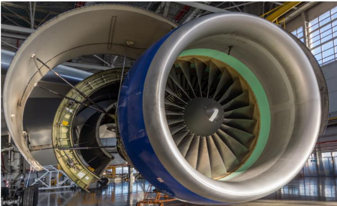
Слика 37. Млазна турбина израђена од композитних материјала са керамичком матрицом. [36]
