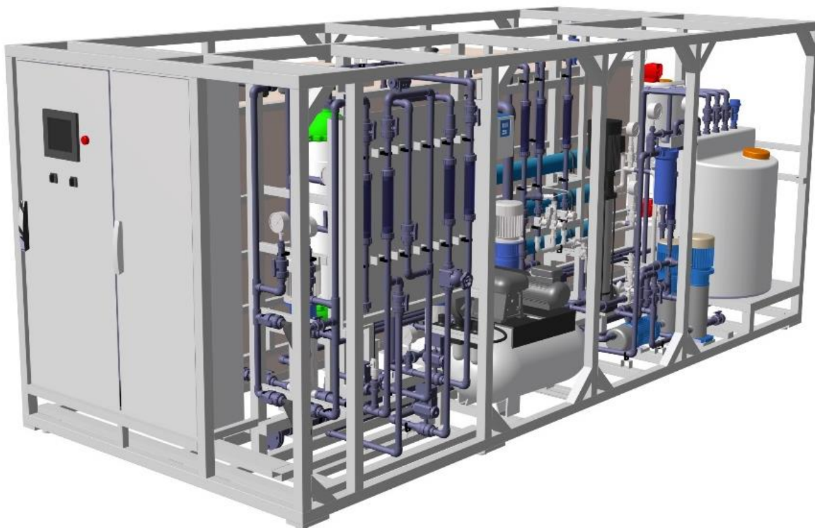
Слика 16: Приказ 3D модела РО система рађеног у софтверу Catia
