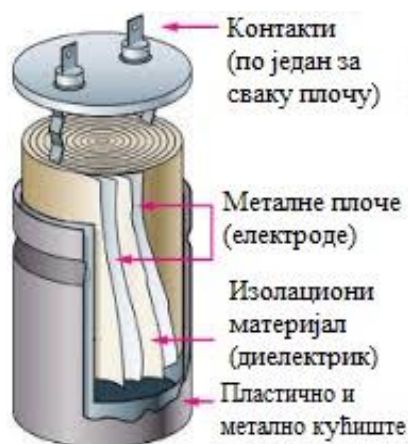
Слика 34. – Илустрација пресека капацитивног давача
