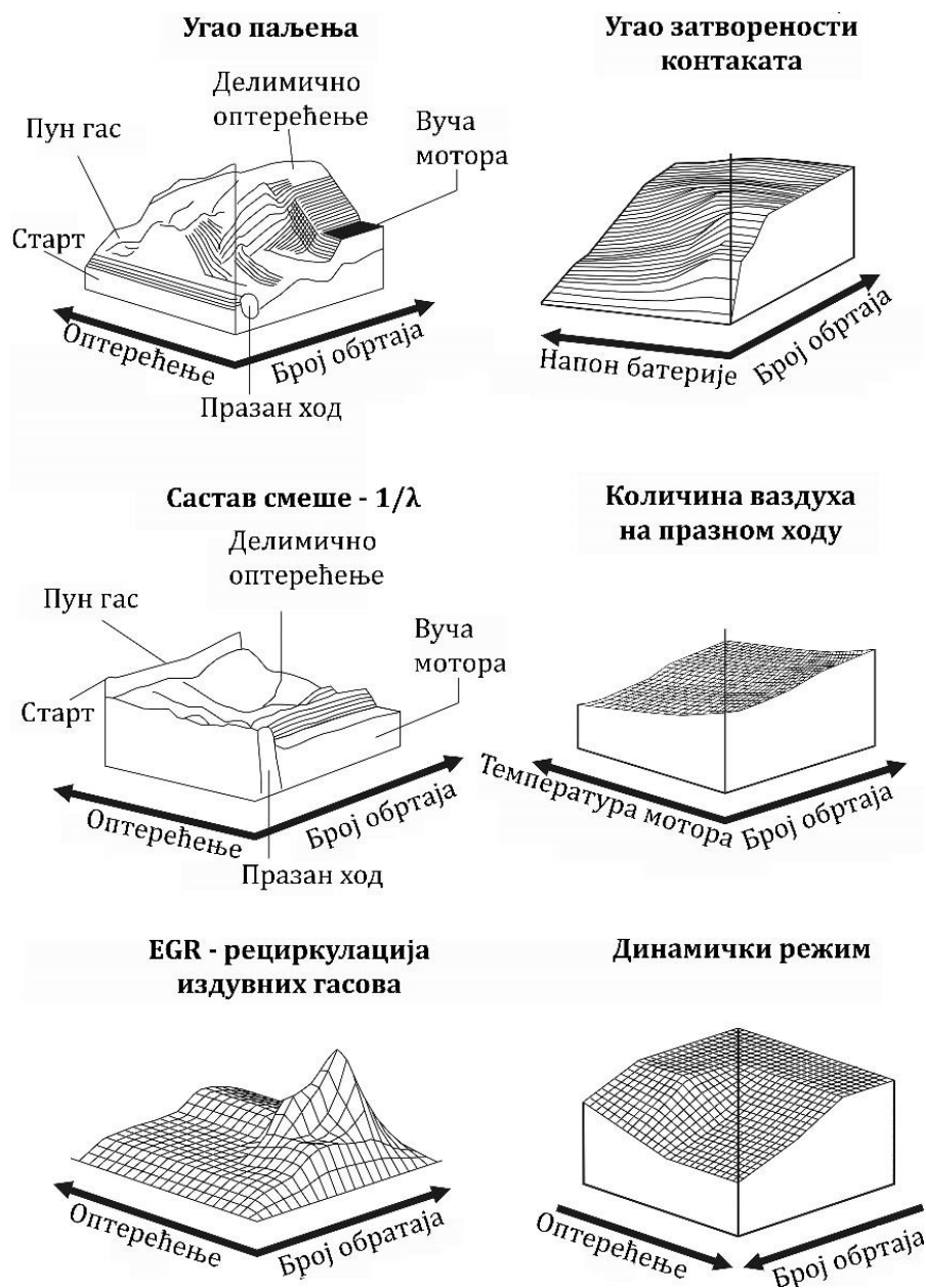
Слика 7.6 Радна поља мотора у возилу [2]
