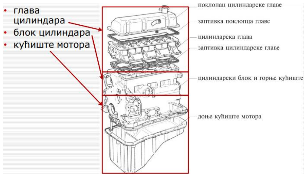
Слика 3.2 Непокретни делови мотора [6]
