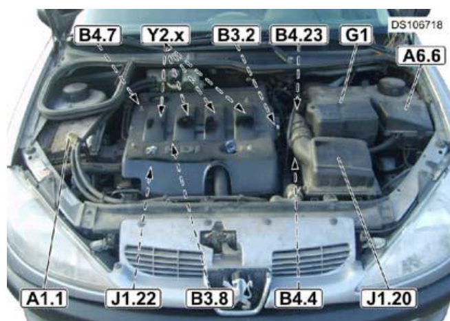
Слика 8.2. Распоред компоненти у моторном простору (A 1.1= ECU мотора, J1.22= Пумпа високог притиска (PVP), B3.8= Давач температуре горива, B4.4= Давач броја обртаја коленастог вратила са референтом ознаком, B4.7= Давач позиције брегастог вратила, Y2.x= Бризгаљке, итд.) [12]
