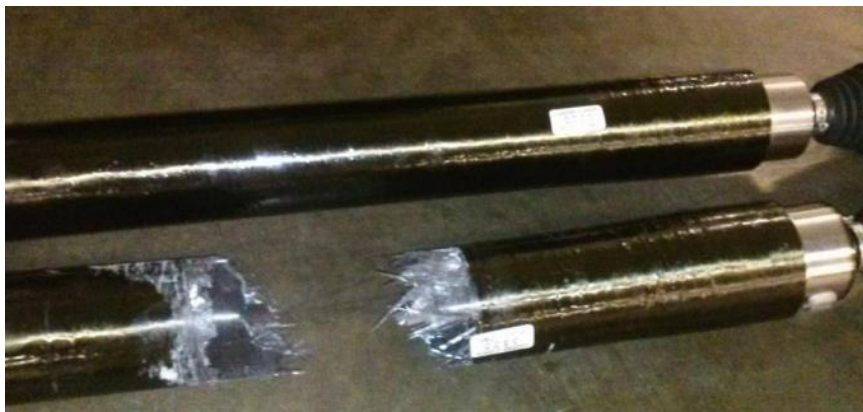
Слика 3.1: Лом композитног карданског вратила [8]
