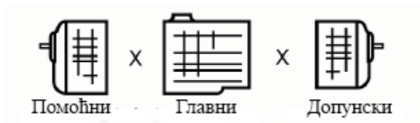
Слика 3.11 – Мануелни мењачки преносник из више сегмената [6]
