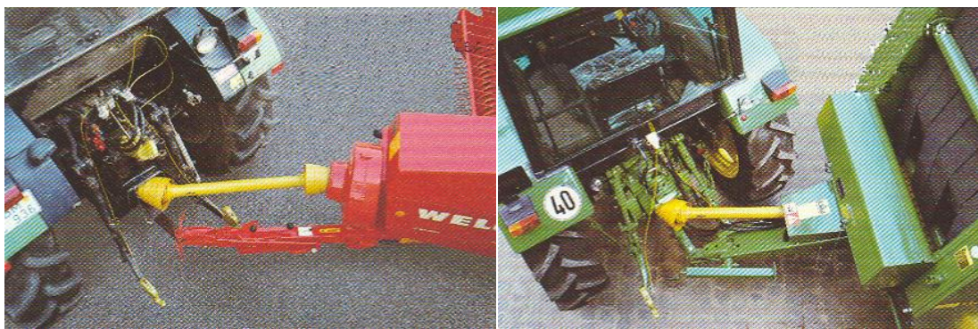
Слика 5.1. Примена кардановог вратила за погон радних органа прикључних машина, [6]
