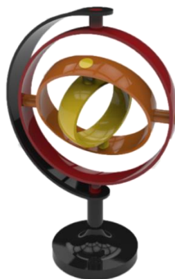
Слика 2.6. Зглобни механизам са три зглобна прстена, [5]
