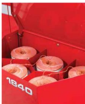
Слика 5.7. Ролне конопца за везивање бала, [7]
