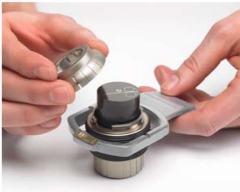
Слика 18. Убацивање металног постоља у холдер
