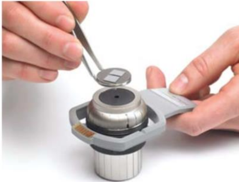
Слика 17. Убацивање игланог стуба у холдер
