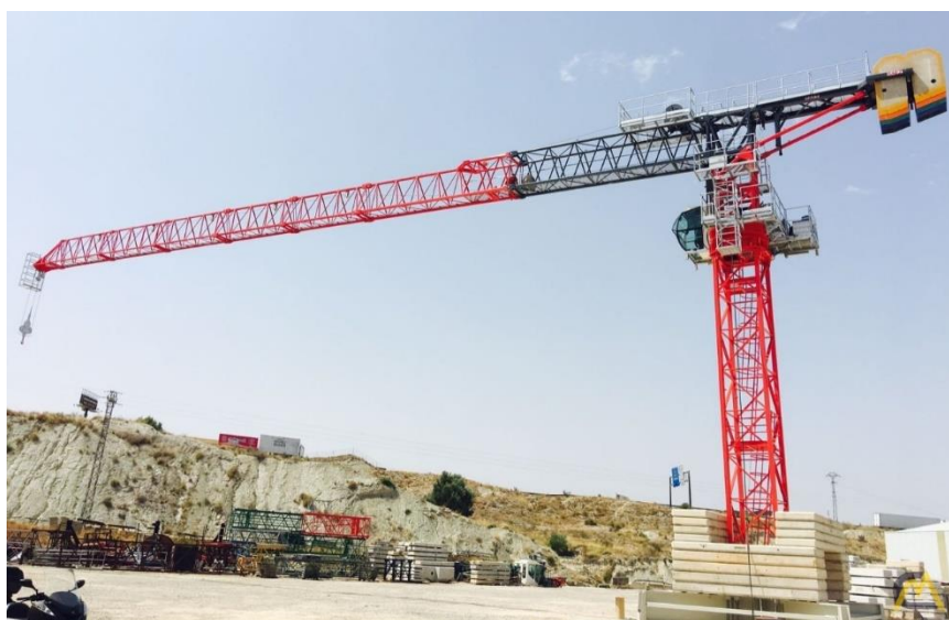
Слика 2.4 Решеткаста конструкција крана [7]
