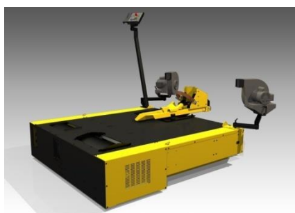
Слика 3.24 Уређај за мерење снаге мотоцикала и ATV возила, DynoJet 200ix: а) DynoJet 200ix уређај са ваљцима, б) DynoWare електронски уређај са софтвером за контролу рада ваљака и очитавање и меморисање резултата мерења [27]
