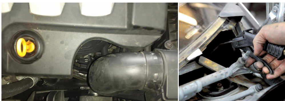
Слика 4.15 Провера везе погонског агрегата са каросеријом возила
