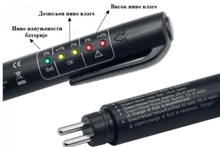
Слика 3.25 Тестер кочионе течности [28]
