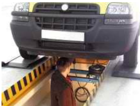
Слика 3.15 Путничко возило постављено на уређај за испитивање СЕО – развлачилице [4]
