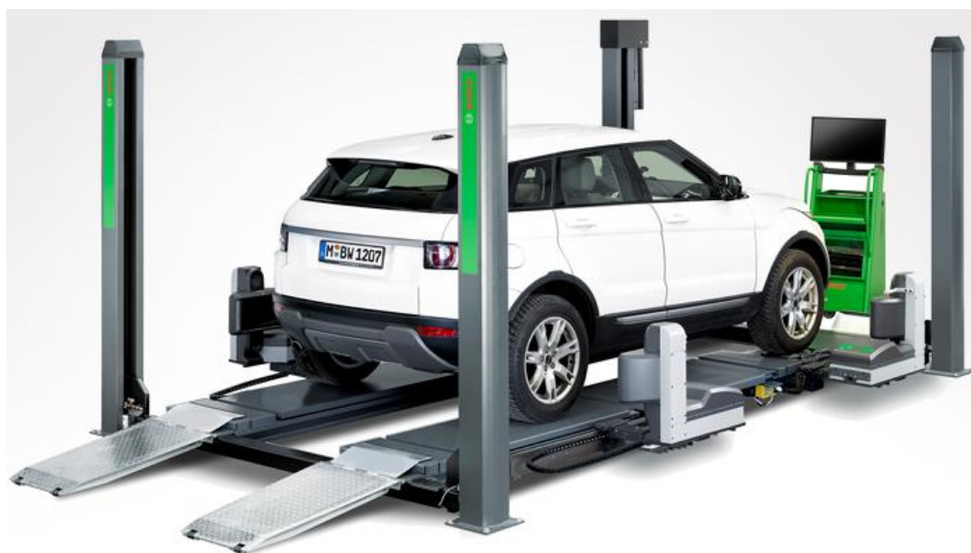
Слика 3.16 Уређај за испитивање и реглажу СЕО возила Bosch FWA 9000 [25]
