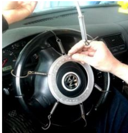
Слика 4.16 Мерење слободног хода точка управљача на возилу VW Golf V [12]
