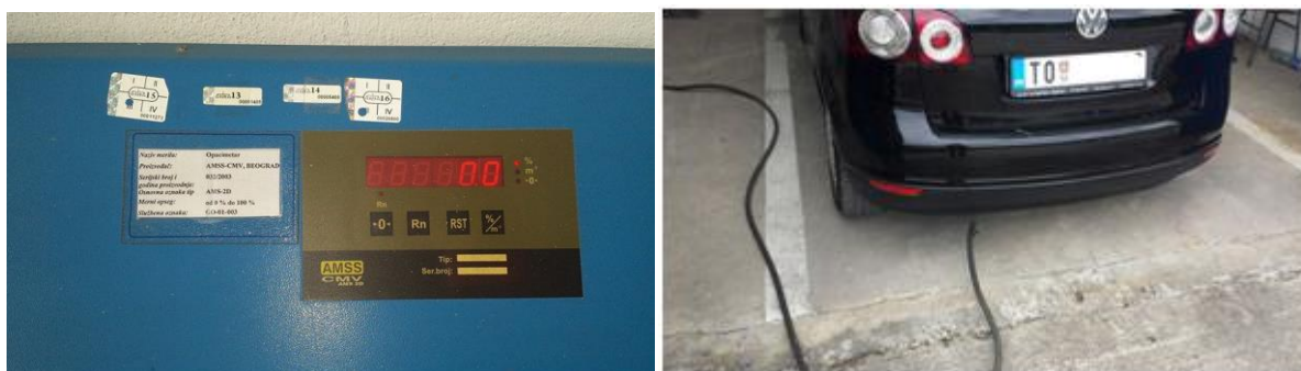
Слика 4.8 Повезивање димометра са издувном цеви возила у конкретном случају
