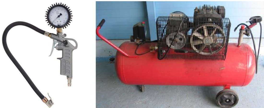
Слика 3.18 Компресор и манометар за мерење притиска у пнеуматичима [12]
