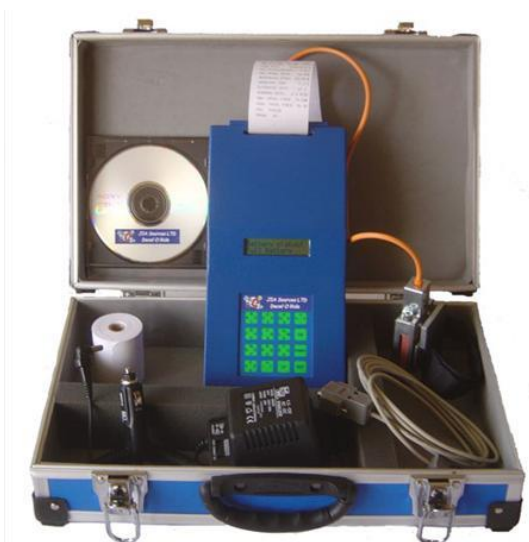
Слика 3.26 Уређај за мерење успорења возила Hofmann Akcel [29]
