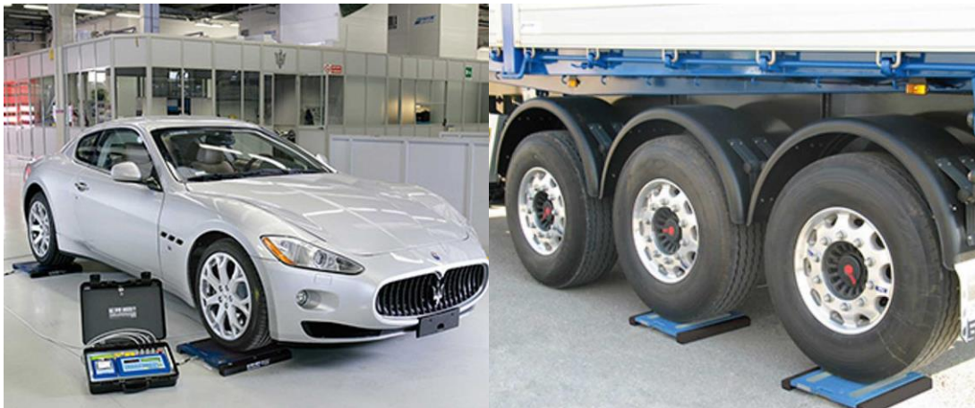
Слика 3.13 Путничко возило и теретно возило постављено на платформу за мерење осовинског оптерећења [24]
