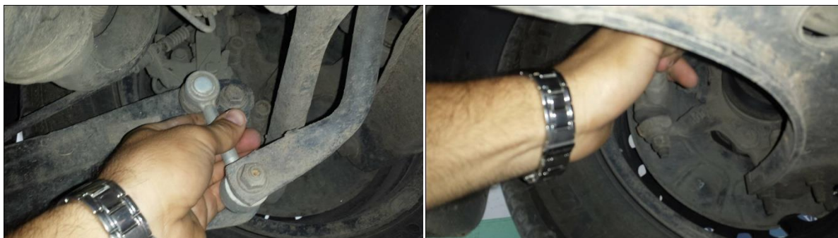
Слика 4.13 Провера спона и везе точка са СЕО
