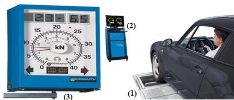
Слика 3.1 Уређај за мерење силе кочења на линијама техничког прегледа возила: 1. ваљци, 2. централна јединица, 3. стуб за обраду и приказ резултата мерења [5,11]
