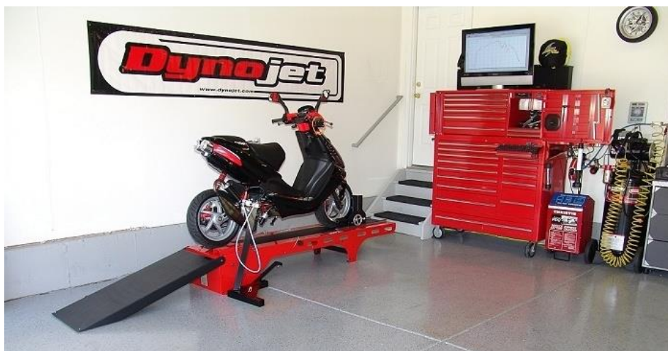
Слика 3.22 Мерење снаге мотоцикла на ваљцима [27]
