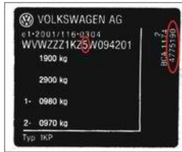
Слика 4.4 Пример броја шасије код возила VW [12]
