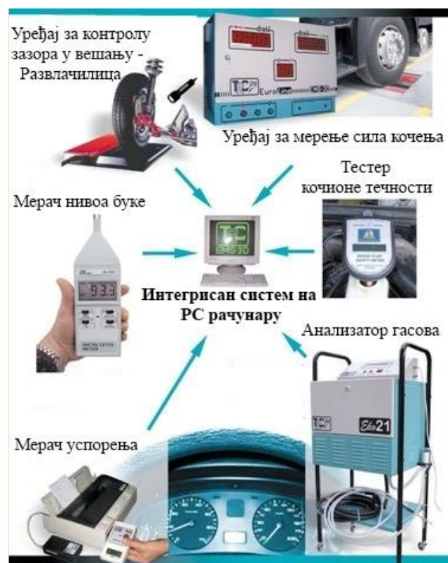
Слика 2.2 Мерни уређаји на линији техничког прегледа интегрисани у јединствен систем [4]
