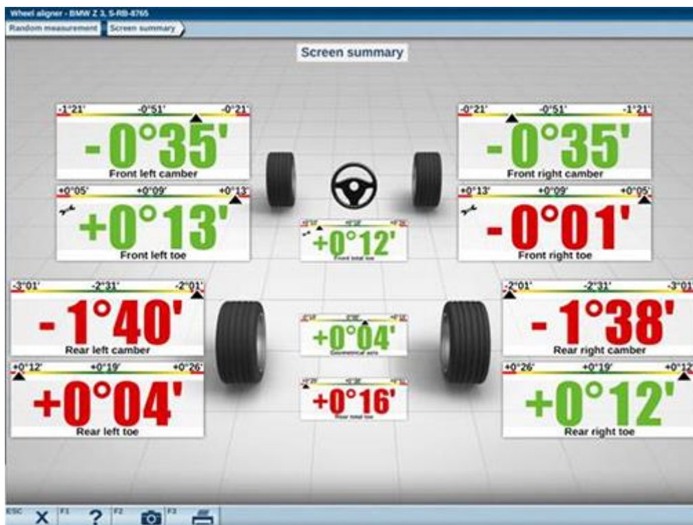
Слика 3.17 Резултати мерења геометрије точкова за возило BMW Z3 (затур, нагиб и распон)[25]
