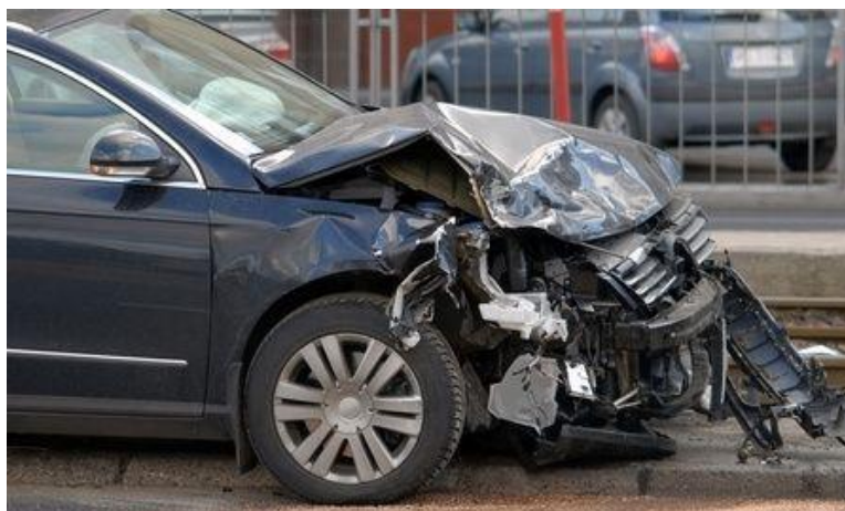
Слика 2.2 Приказ оштећења предњег дела возила
