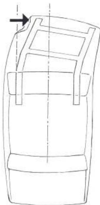
Слика 2.1.1 Шема удarca предњег дела возила
