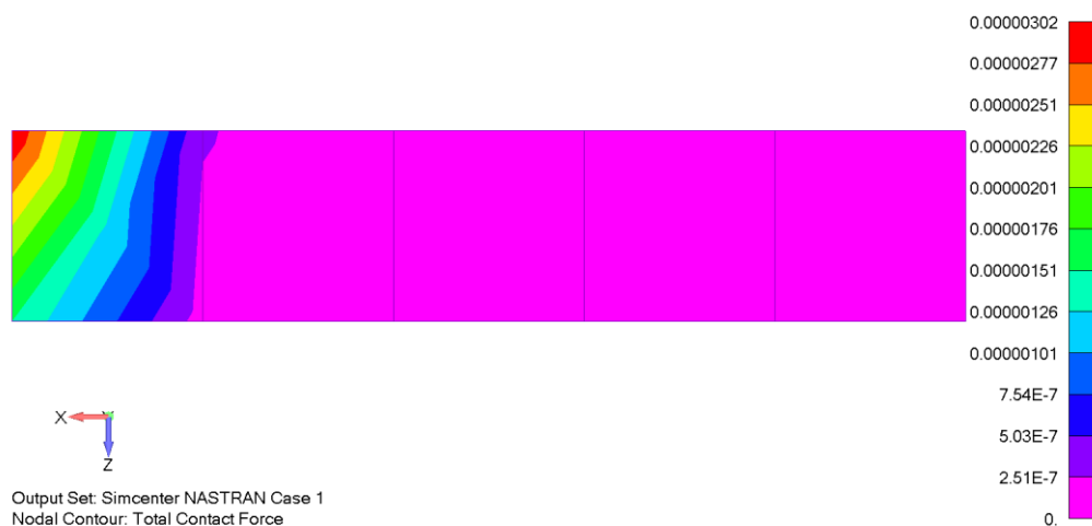
Слика 5.2.8 Поље укупних контактних сила у депонованом материјалу
