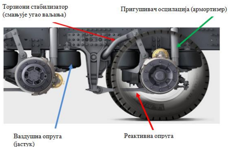
Слика 7.8. Пнеуматски сиситем ослањања „Mercedes-Benz”, Actros 6x4 [26].
