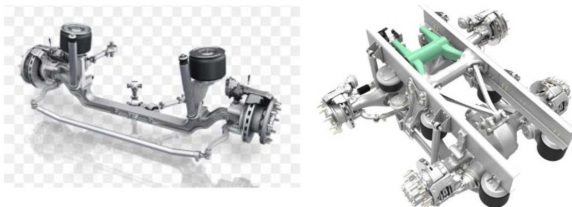
Слика 7.9. Систем пнеуматског ослањања предње осовине-лево и погонског моста - десно, формуле 6x4, ZF [28].
