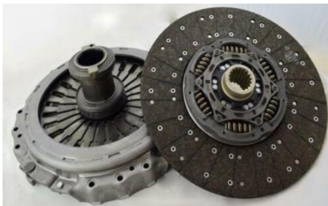
Слика 7.3. Делови фриксионе спојнице- лево [27], и спојница произвођача “SACHS” за погонски агрегат МВ ОМ 936, \phi = 430\text{mm} - десно [26].
