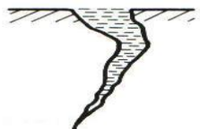
Слика 3.7 Стање површине након одстрађивања пенетранта са површине (пенетрант само у прслини)
