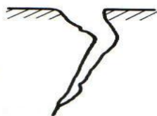
Слика 3.5 Стање површине нужно за провођење испитивања (одстрађивање нечистоће)
