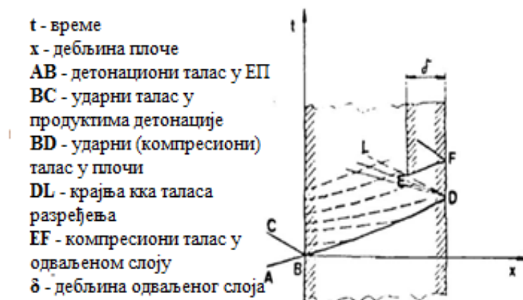
Слика 15: Кретање таласа у плочи при појави одваљивања [2]
