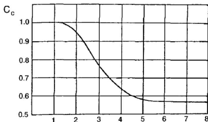
Слика 36: Зависност коефицијента C од параметра \sqrt[3]{\frac{m_E}{K}} / h [1]
