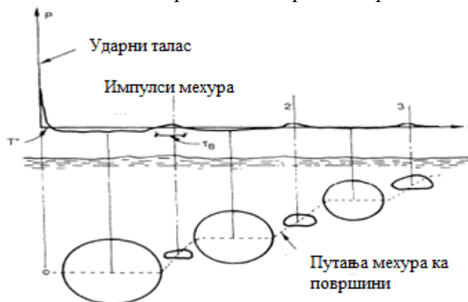
Слика 46: Зависност притиска од времена при подводној експлозији: ударни талас и осцилације притиска у мехуру [1]
