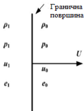
Слика 11: Основни параметри равног ударног таласа у чврстом телу [1]
