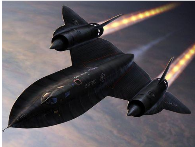
Слика 3.7 SR-71 "Црна птица" чију конструкцију чини легура \beta -титана (Ti13V11Cr3Al) [11]
