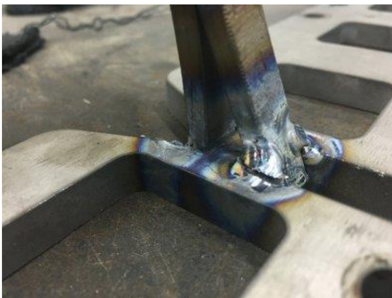
Слика 5.10 Пукотина која је настала при заваривању титана [22]
