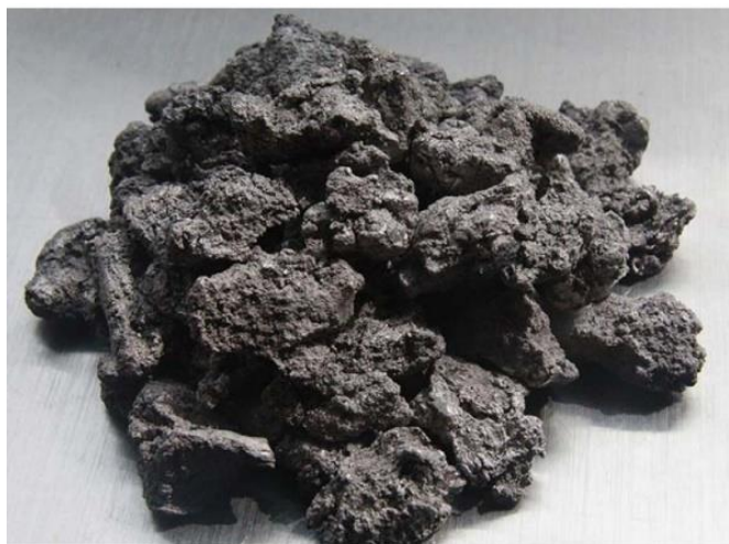
Слика 2.5 Изглед сунђерастог титана добијеног Кроловим поступком [7]
