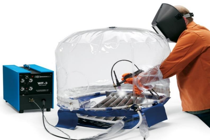
Слика 5.4 Извођење ТИГ заваривања у пластичној комори испуњеној аргоном [17]
