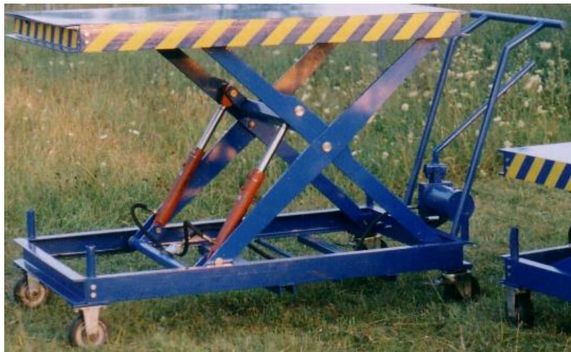
Слика 19. Конструкција платформе са ручним погоном покретним постолем
