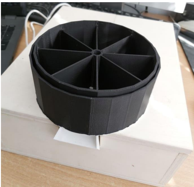
Слика 90: Изглед силоса који регулише број порција које треба да се послужи љубимцу
