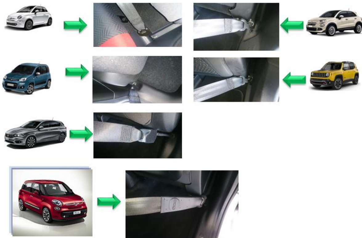
Слика 18 – Уклонити заштиту на сигуросном појасу
