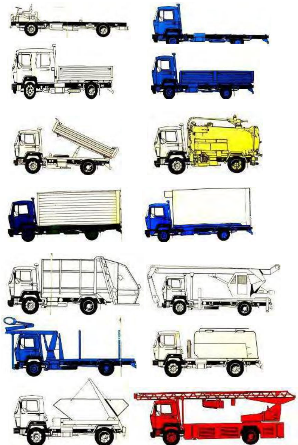
Слика 3.30 - Различите надградње на истом шасијском раму савременог теретног возила[4]
