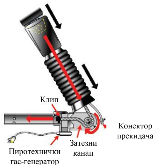
б) принцип затезања појаса пиротехничким предзатезачем
