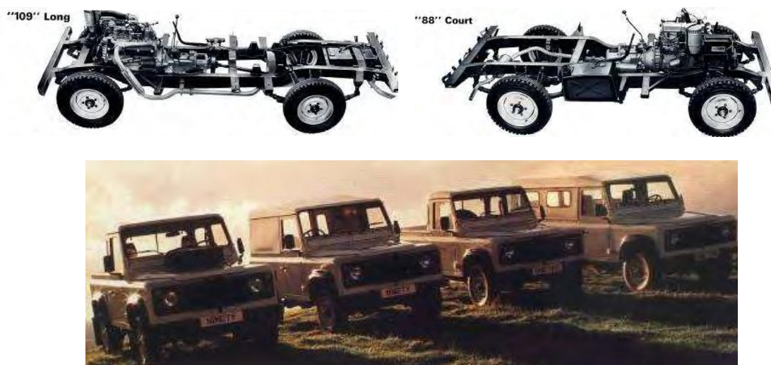
Слика 3.33 - Каросерија са делимично интегрисаним шасијским рамом, Ланд Ровер, [4]
